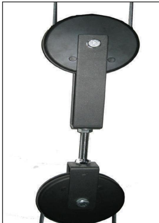
All'inizio ci sarà una naturale estensione del cavo, che è un processo normale e non un difetto di qualità. Per regolare, girare il dado in senso orario e il cavo viene teso. In senso antiorario, il cavo viene allentato.
